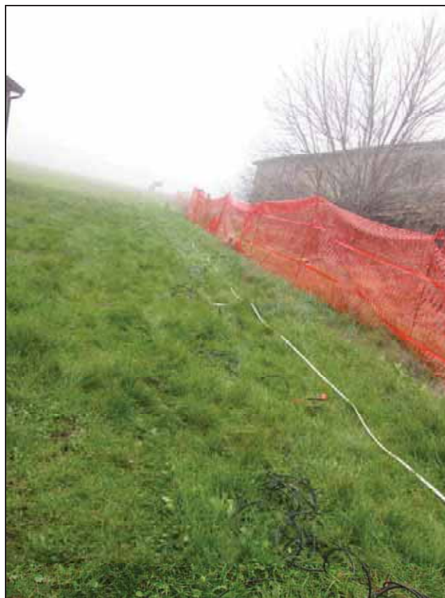
Fig. 4.4: Ripresa fotografica di parte dello stendimento Masw.
